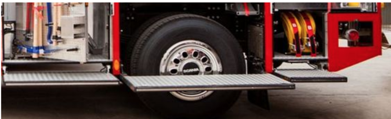
Figura demonstrativa de Estribos dobráveis pretendidos
